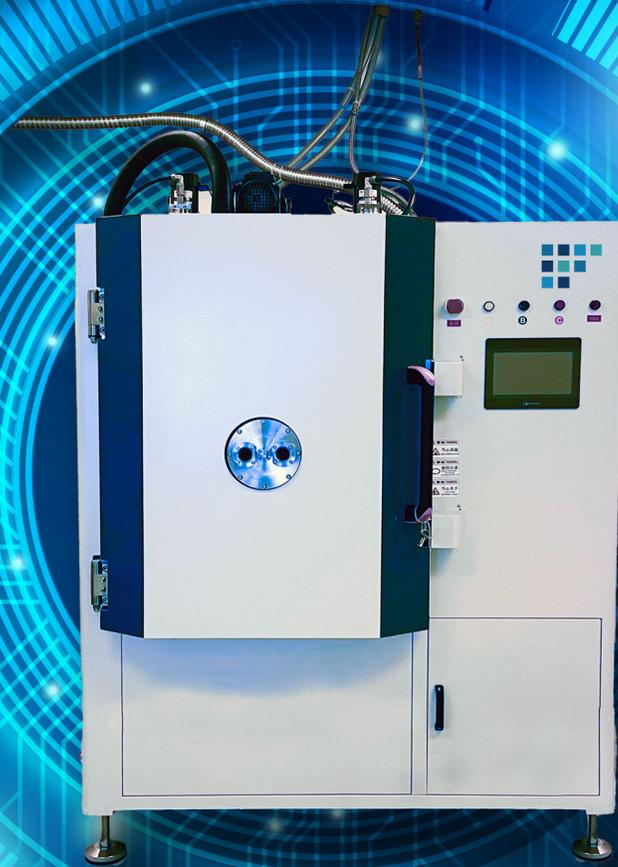
**El tratamiento de superficie StenTech BluPrint™ CVD (depositado por vapor químico)** representa una técnica innovadora para aplicar películas delgadas de material sobre un sustrato. Este proceso innovador implica introducir precursores químicos en la cámara de un reactor, donde sufren reacciones químicas y se solidifican como un material depositado en la superficie del sustrato.
